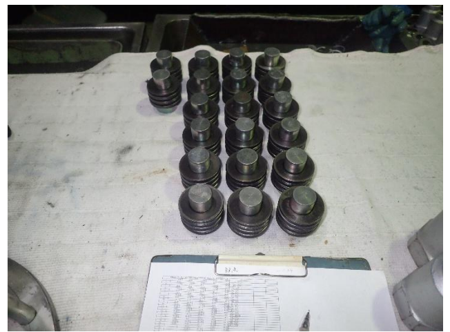
第2ロマンスリフト 握索機バネ更新
