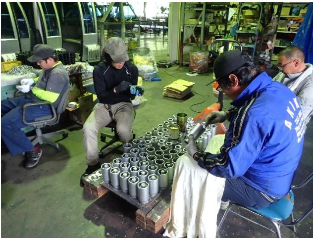
第1ロマンスリフト 握索機バネ更新
